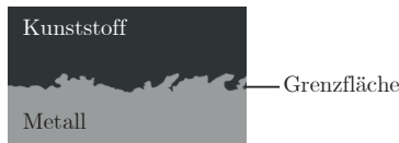
Abbildung 2.3: Schematische Darstellung der Grenzfläche einer MKV zur Verdeutlichung der mechanischen Adhäsion durch (Mikro-)Formschluss
